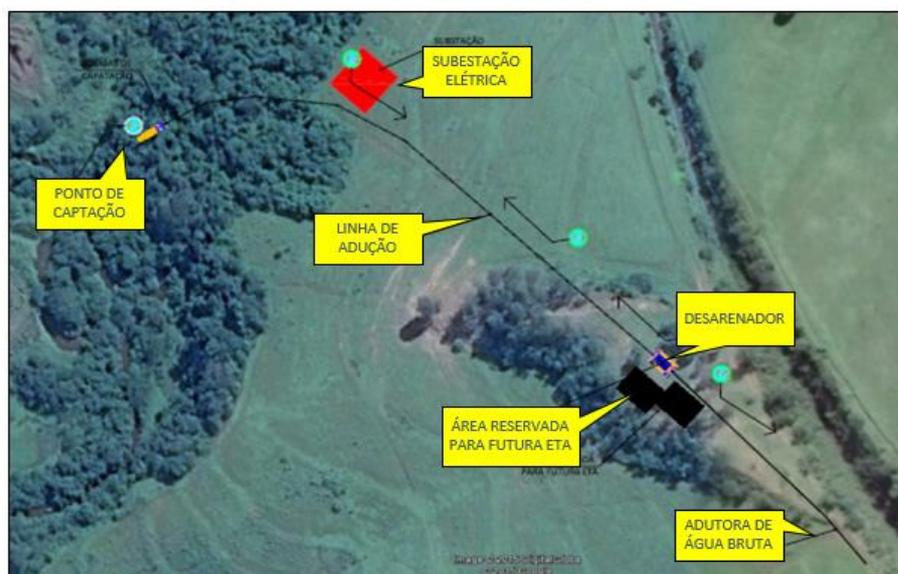
Figura 8. Croqui da nova captação de água bruta (imagem cedida pelo SAAE)
